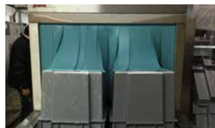
Túnel para el lavado de cajas Tunnel for washing boxes Tunnel pour laver les caisses
